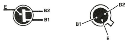
Fig. 4. Rappresentazione grafica dei transistor unigiunzione e disposizione dei relativi terminali nello zoccolo.
